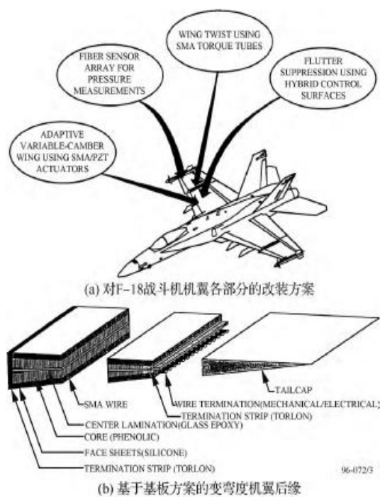
图 21 Smart Wing 项目第 1 期的机翼改装方案 [83]
