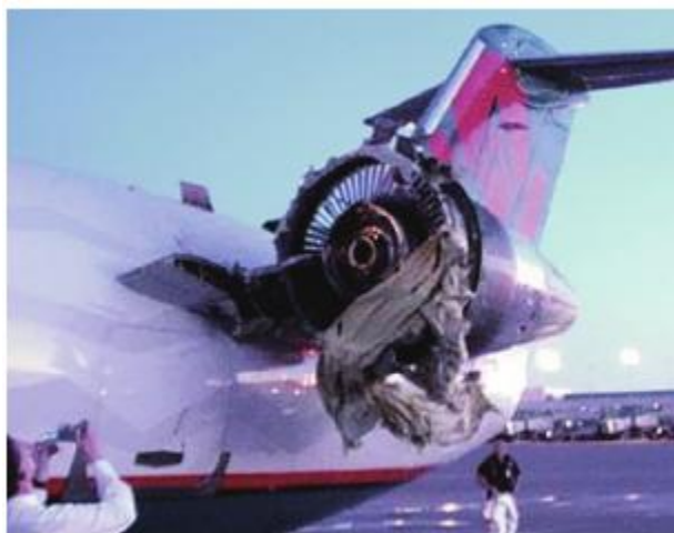
图4 风扇转子、包容机匣等均在飞行中丢失
