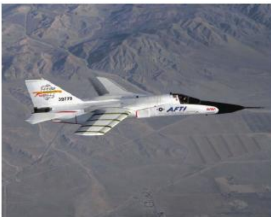
图 20 MAW 项目中经改装后的 F111 飞机 [26] Fig. 20 Modified F111 aircraft in MAW program [26]
