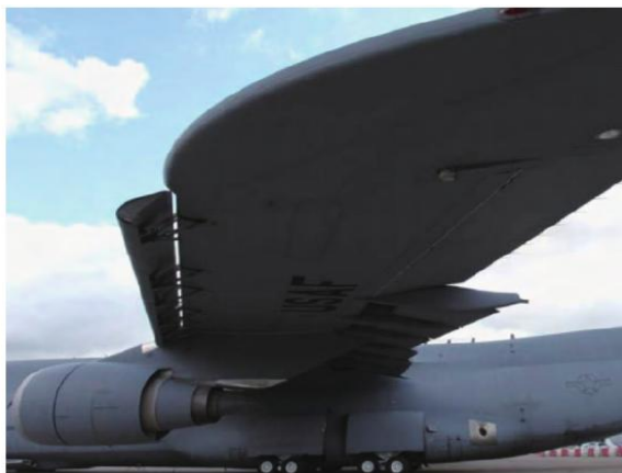
图3 前缘缝翼与主翼面之间的缝隙 [15]
