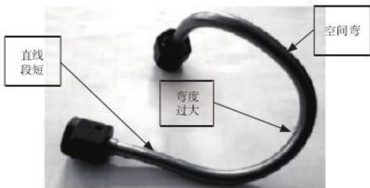
图2 无法进行数控弯管的导管示意图
