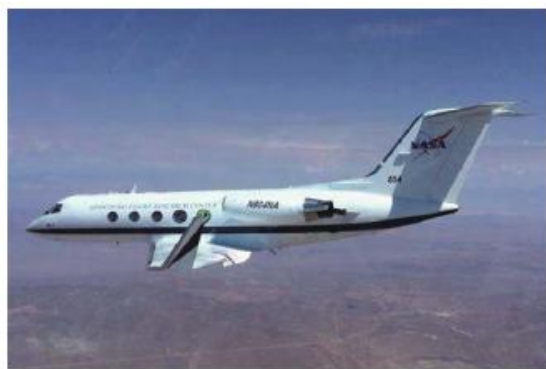
图 23 在飞行中机翼后缘下偏的湾流 III 飞机 [21]
