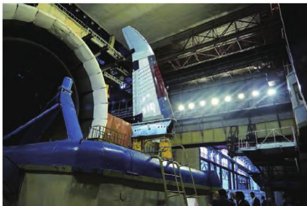
图 30 在俄罗斯 TsAGI T-104 风洞中进行测试的变体机翼样机
