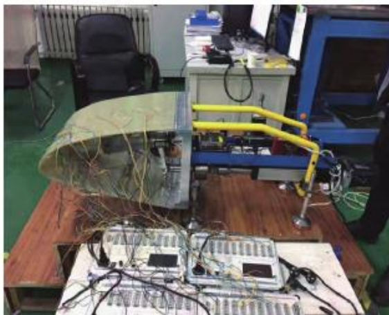
图 18 可变弯度机翼前缘实验装置 [61]
