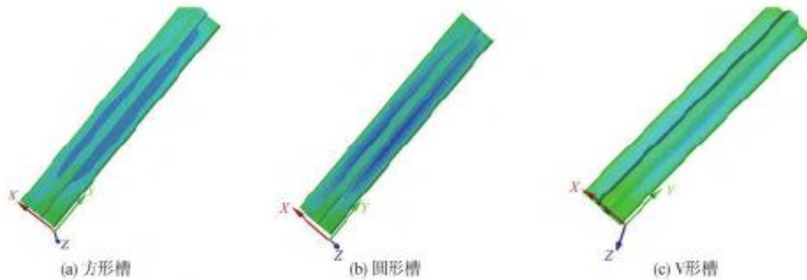
图9 热电偶直径1.0mm三种方案涂层部分XY平面切应力分布
