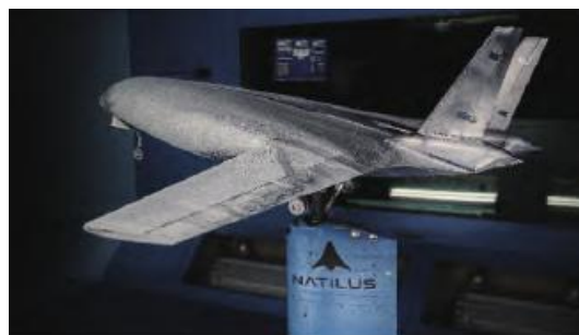
(b) N3.8T货机1/10缩比风洞试验模型
